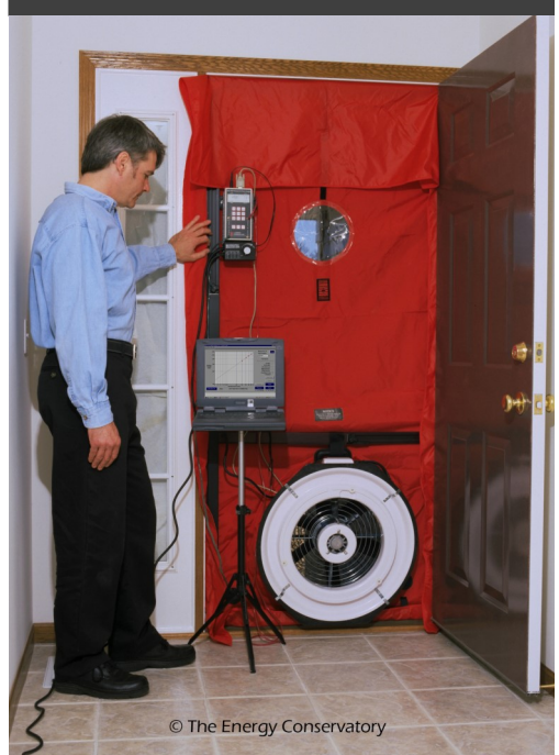
Blower Door Test
